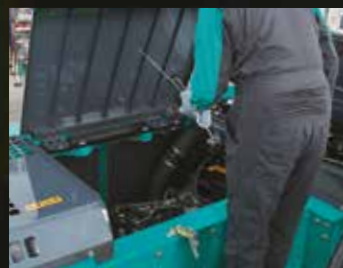
Motoronderhoud Een speciale lagere trede bij de motor vereenvoudigt onderhoudswerkzaamheden.
