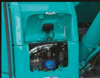
DEF-tank op grondniveau
